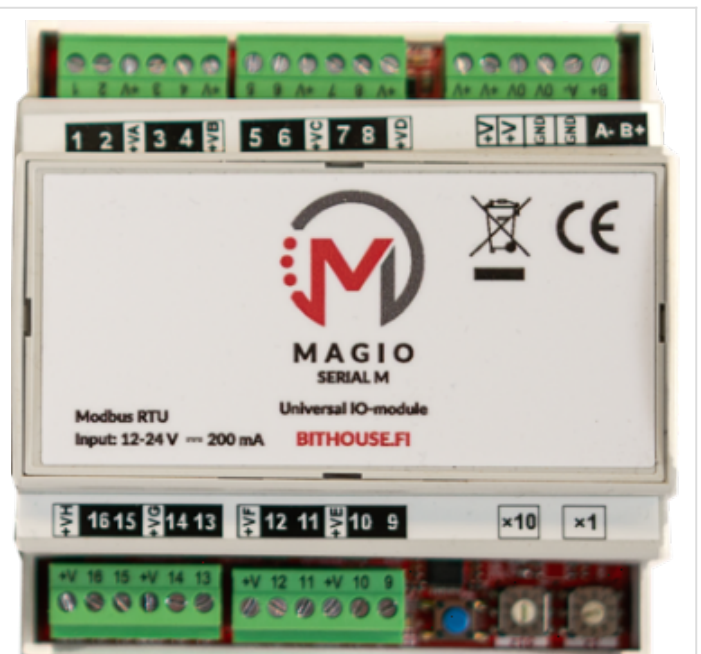
Magio Serial M kortti DIN-kotelossa. Kotelo on 5 DIN moduulin kokoinen. L: 88mm, 91mm (97mm kiinnikkeen kanssa), S: 62mm
